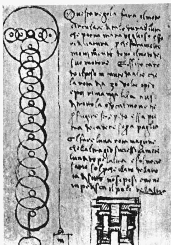
Una applicazione di perni su rulli. In basso: vista in pianta di coppie di rulli. (Ms. I - 58 r).
