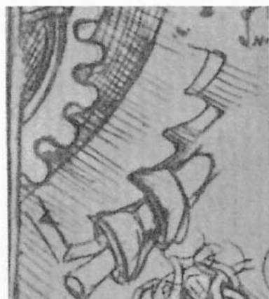
Ruota dentata con denti a sezione trapezia - Ms. B, fol. 73 verso
