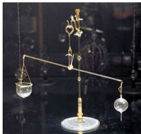
Bilancetta idrostatica (Istituto Museo di Storia della Scienza, Firenze, Collezioni Medicee)
